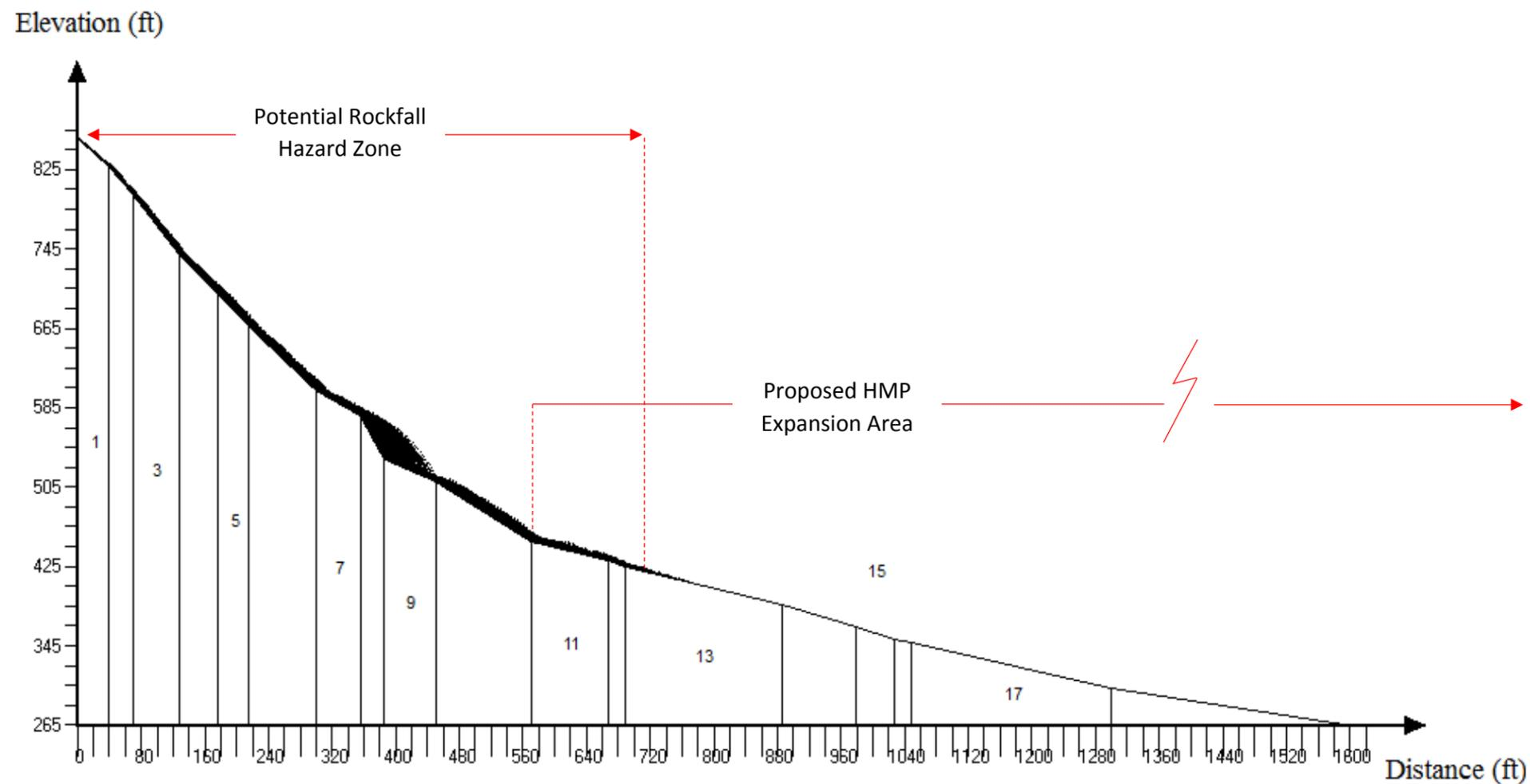
POTENTIAL ROCKFALL SIMULATION – SLOPE PROFILE “E”
