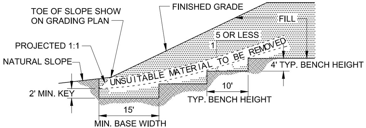
**FILL SLOPE ON SLOPING GROUND**
